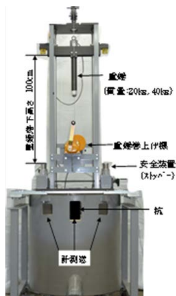
写真-2-(1) 円形軸対称衝撃支持力実験機
